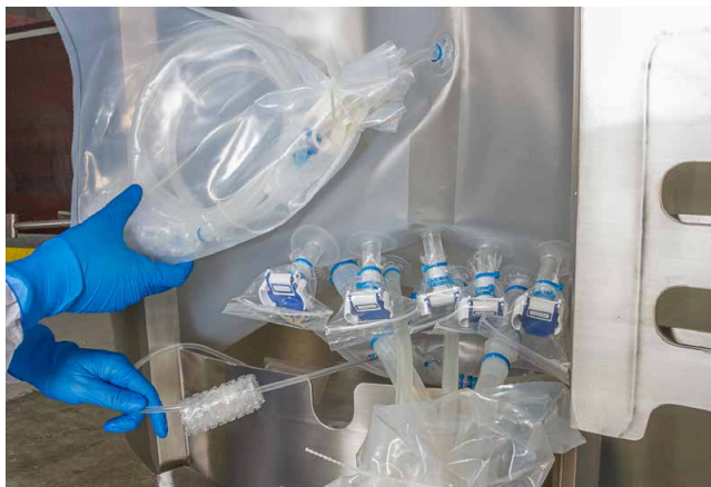
图 3.69. 通过前检修门的进料管路。
