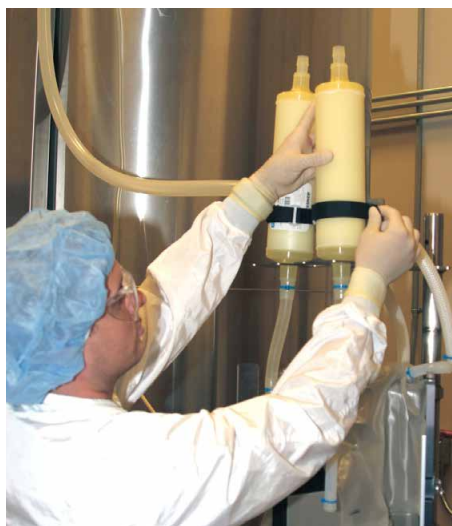
图 3.80. 固定排气过滤器。
