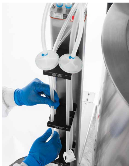
图 3.9. 将管线插入电缆管理系统通道中。
