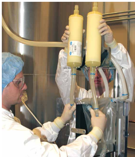
图 3.79. 放置排气过滤器。
