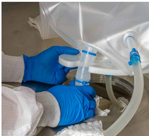
图 3.71. 排放管路支撑。
