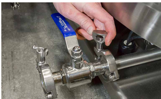
图 2.4. 使用三卡箍连接水夹套端口。
