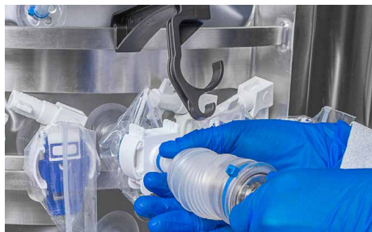
图 3.122. 塌缩的波纹管。
