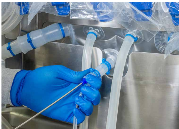
图 3.106. 将 RTD 插入热电偶套管。
