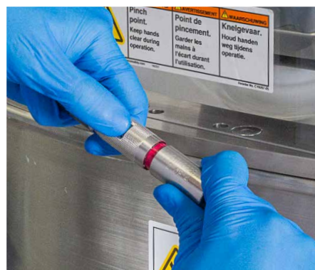
图 3.95. 滑动衬套露出红色“未锁止”指示器。
