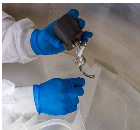
图 3.60. 将拉环连接到 BPC 升降机。
