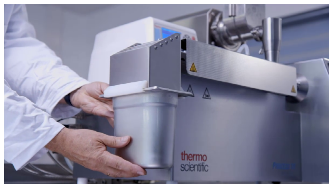
図2. 造粒機キットを装備したProcess 11二軸スクリーエクストルーダー
