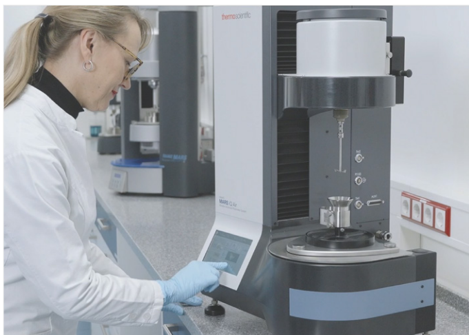
Abbildung 1. HAAKE MARS iQ Rheometerkonfiguration für Pulverrheologie: Ausführen einer SOP per Knopfdruck am Rheometer-Touchscreen.
