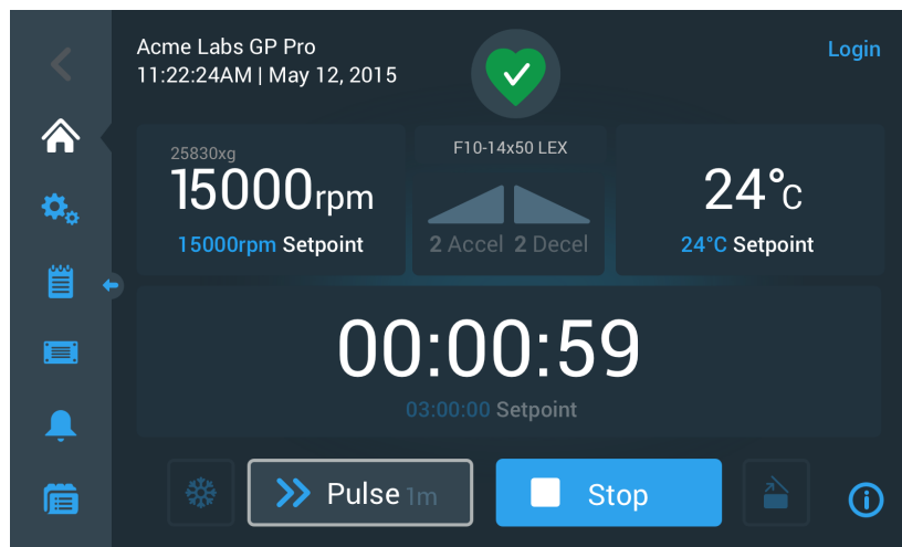
Abbildung 3–25: Pulse-Modus: Zentrifuge läuft eine Minute lang
