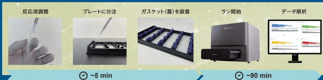
図1 QuantStudio Absolute Q デジタルPCRシステムのワークフロー
