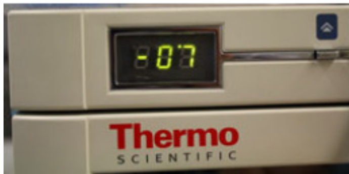
Abbildung 7-2: Angezeigter Regelkorrekturwert von -0,7 °C im Display
