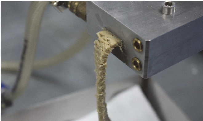
植物性タンパク質を押出混練するために専用設計されたスリットダイ
