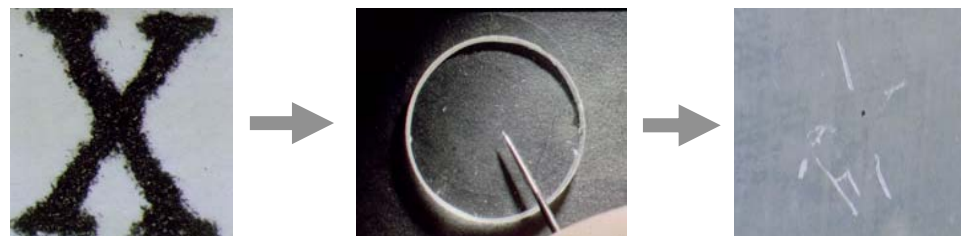
コピー用紙からコピー用紙に転写したものをBaF 2 板上にサンプリングしたものを透過測定
