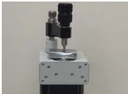
ConservatIR アームヘッドにATRアッセンブリを装着、 サンプルをダイヤモンドクリスタルに接触させている様子
